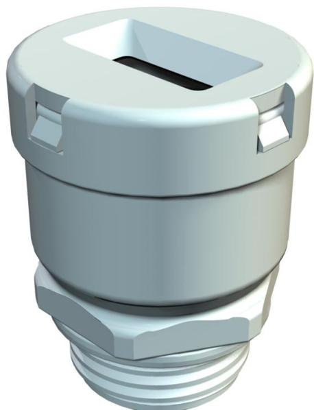
Modello di passacavo per cavo piatto con bocchettone pressacavo dotato di filettatura metrica secondo IEC 432, grado di protezione IP 31, con guarnizione interna 107/F M premontata.
