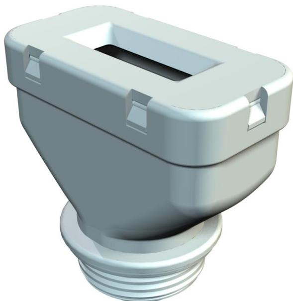
Entrée avec raccord d'étranglement pour câbles plats, avec filetage métrique selon la norme CEI 432, indice de protection IP 31, avec bague d'étanchéité pré-montée de type 107/F.
