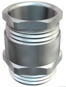
Pressacavo con adattatore esagonale, forma C4 secondo DIN 46320 con raccordo filettato metrico secondo DIN EN 60423 o ISO 68. Guarnizione in acciaio, zincato galvanicamente e passivato trasparente. Guarnizione interna in NR/SBR.
