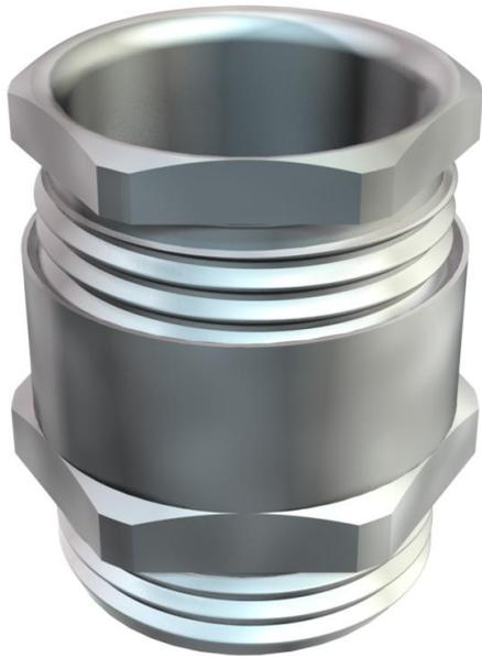
Kabelverschraubung mit Sechskant-Zwischenstutzen, Form C4 nach DIN 46320 mit metrischem Anschlussgewinde nach DIN EN 60423 bzw. ISO 68. Druckringe Stahl, galvanisch verzinkt und transparent passiviert. Dichtring aus NR/SBR. Schutzart: mit Anschlussgewinde-Dichtring IP65, ohne Anschlussgewinde-Dichtring IP54. Mit einfachen Dichtring, mit kleinem Innendurchmesser. \* Preise laut DEL-Notierung.
