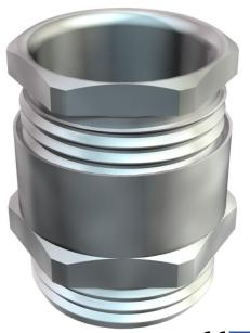
Kabelverschraubung mit Sechskant-Zwischenstutzen, Form C4 nach DIN 46320 mit metrischem Anschlussgewinde nach DIN EN 60423 bzw. ISO 68. Druckringe Stahl, galvanisch verzinkt und transparent passiviert. Dichtring aus NR/SBR. Schutzart: mit Anschlussgewinde-Dichtring IP65, ohne Anschlussgewinde-Dichtring IP54. Mit einfachen Dichtring, mit kleinem Inennendurchmesser. \* Preise laut DEL-Notierung.
