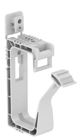
Passe-câbles pour utilisation générale avec trous de fixation de 6 mm  $\varnothing$ , adaptée à la fixation au mur et au plafond. Le tampon de fixation moulé par injection peut être fixé à l'aide de chevilles à frapper ou d'une machine à clouter. La distance de fixation recommandée à équipement complet est de 250 - 400 mm. Avec élément de fixation multifonctionnelle.
