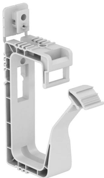
Passe-câbles pour utilisation générale avec trous de fixation de 6 mm Ø, adaptée à la fixation au mur et au plafond. Le tampon de fixation moulé par injection peut être fixé à l'aide de chevilles à frapper ou d'une machine à clouter. La distance de fixation recommandée à équipement complet est de 250 - 400 mm. Avec élément de fixation multifonctionnelle.
