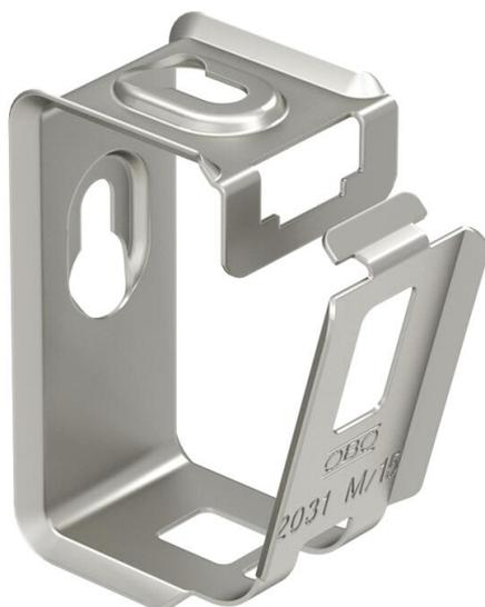
Graffa di supporto multipla in metallo per una elevata resistenza alle sollecitazioni meccaniche anche in caso d'incendio. Adatta per il montaggio sicuro al di sopra di controsoffitti con protezione antincendio. Anche ammessa come versione specifica dei cavi per il mantenimento funzionale elettrico secondo DIN 4102 parte 12. Per montaggio a parete e a soffitto. Riapertura possibile senza attrezzi.
