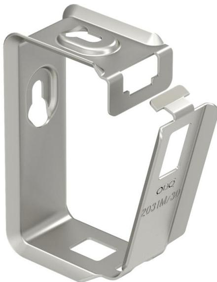
Sammelhalter aus Metall für hohe mechanische Standfestigkeit, auch im Brandfall. Zur sicheren Montage oberhalb von Brandschutzdecken geeignet. Auch als kabelspezifische Variante für den elektrischen Funktionserhalt nach DIN 4102 Teil 12 zugelassen. Für Wand- und Deckenmontage. Verschluss ohne Werkzeuge zu öffnen.
