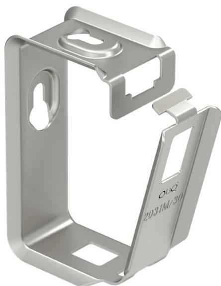
Graffa di supporto multipla in metallo per una elevata resistenza alle sollecitazioni meccaniche anche in caso d'incendio. Adatta per il montaggio sicuro al di sopra di controsoffitti con protezione antincendio. Anche ammessa come versione specifica dei cavi per il mantenimento funzionale elettrico secondo DIN 4102 parte 12. Per montaggio a parete e a soffitto. Riapertura possibile senza attrezzi.
