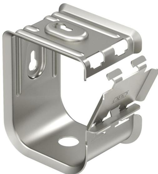
Graffa di supporto multipla in metallo per una elevata resistenza alle sollecitazioni meccaniche anche in caso d'incendio. Adatta per il montaggio sicuro al di sopra di controsoffitti con protezione antincendio. Anche ammessa come versione specifica dei cavi per il mantenimento funzionale elettrico secondo DIN 4102 parte 12. Per montaggio a parete e a soffitto. Riapertura possibile senza attrezzi.
