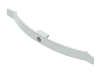
Flammwidrige Ausführung, speziell für die Verwendung in Zwischendecken. Thermopl. Polyester, steingrau RAL 7030, flammwidrig nach VDE 0471/DIN IEC 695 Teil 2-1, Prüftemperatur 960°C, bzw. V-O nach UL 94, halogenfrei. Klemmhöhe 9 mm, mit Distanzstück 13 mm. Befestigungsloch 6 mm Ø. 2033/F für max. 16 Leitungen NYM 3 x 1,5 mm²
