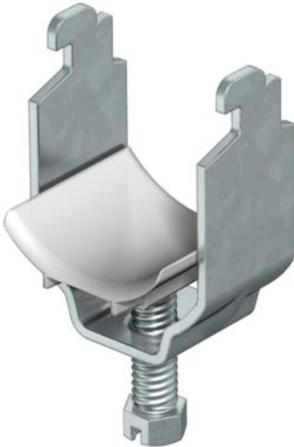
Convient à tous les rails profilés en C d'une ouverture de 11 à 12 mm, d'une hauteur intérieure d'au moins 6,5 mm et d'une largeur intérieure d'au moins 18,5 mm.
