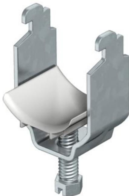
Adatta per tutti i profilati a C con larghezza delle asole compresa tra 11 e 12 mm con altezza interna libera di almeno 6,5 mm e larghezza interna libera di almeno 18,5 mm.
