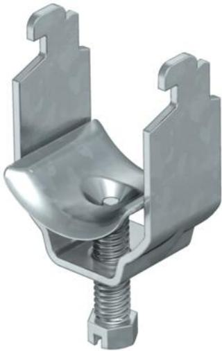
Convient à tous les rails profilés en C avec une ouverture de 11 à 12 mm; hauteur intérieure d'au moins 6,5 mm et largeur intérieure d'au moins 18,5 mm; les plaques de pression métalliques ont des arêtes très arrondies sur toutes les faces pour éviter que les câbles ne soient endommagés. Modèle avec écrou à souder et/ou contre-écrou destiné à une utilisation dans des conditions difficiles et nécessitant une résistance aux secousses sur demande!
