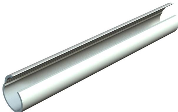
Tubo aperto Quick-Pipe in plastica per il montaggio a parete di cavi e linee in ambienti interni e ambienti esterni protetti. Montaggio a parete e a soffitto con gaffetta Quick, gaffetta Star-Quick e gaffetta Multi-Quick. Chiusura senza attrezzi e apertura tramite rotazione della gaffetta. Utilizzabile in un intervallo di temperature da - 25° a + 60° C.
