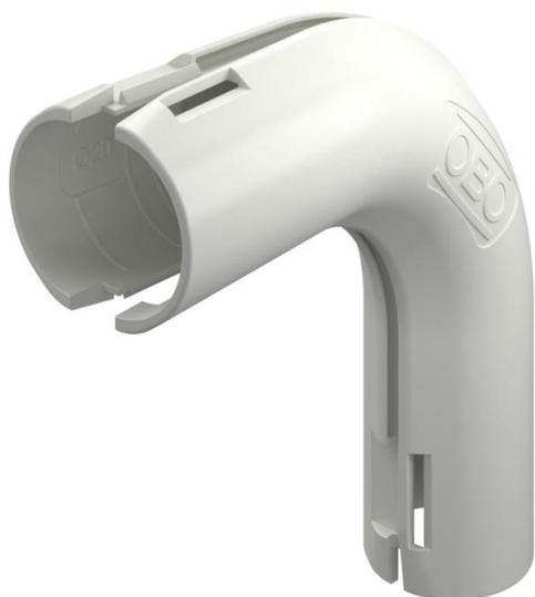
Accessorio per tubi per installazione elettrica in plastica per creare curve a 90°. Adatto per tubo Quick-Pipe o tubo ondulato. Chiusura e apertura senza attrezzi. Utilizzabile in un intervallo di temperature da - 25° a + 60° C.
