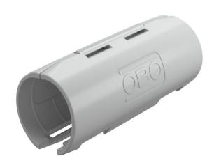
Manicotto di collegamento per tubi per installazione elettrica in plastica per creare collegamenti longitudinali. Adatto per tubo Quick-Pipe o tubo ondulato. Chiusura e apertura senza attrezzi. Utilizzabile in un intervallo di temperature da -  $25^\circ$  a +  $60^\circ$  C.
