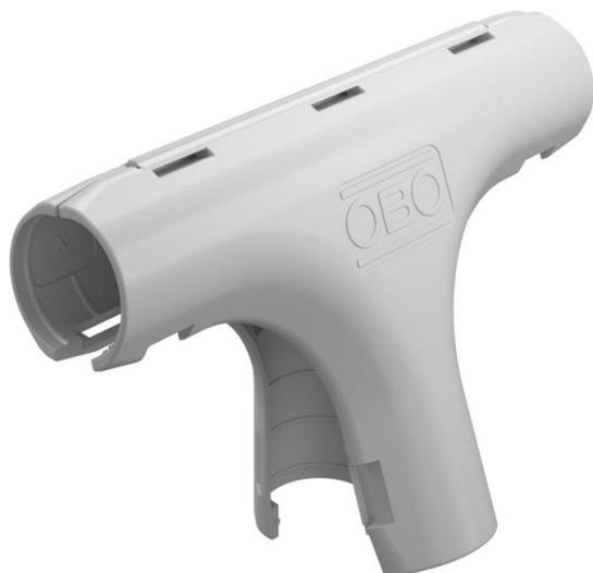
Élément préformé pour tubes d'installation électrique en matière plastique pour créer des dérivations en T. Convient aux tubes Quick-Pipe ou tubes ondulés. Fermeture et ouverture sans outils. Utilisation possible à des températures comprises entre -25 °C et +60 °C.
