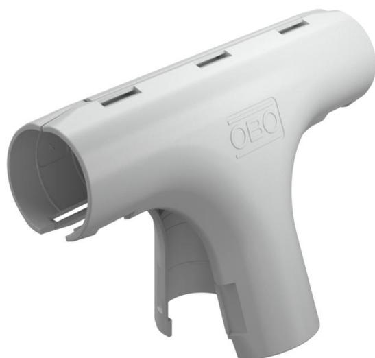
Accessorio per tubi per installazione elettrica in plastica per creare derivazioni a T. Adatto per tubo Quick-Pipe o tubo ondulato. Chiusura e apertura senza attrezzi. Utilizzabile in un intervallo di temperature da - 25° a + 60° C.
