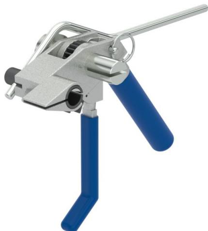
Strumento di serraggio per tutti gli espansori OBO in combinazione con tappi espansori corrispondenti. Con forza di tensione elevata, funzione a scatto, dispositivo di riduzione della lunghezza e maniglie tonde per una pratica maneggevolezza.
