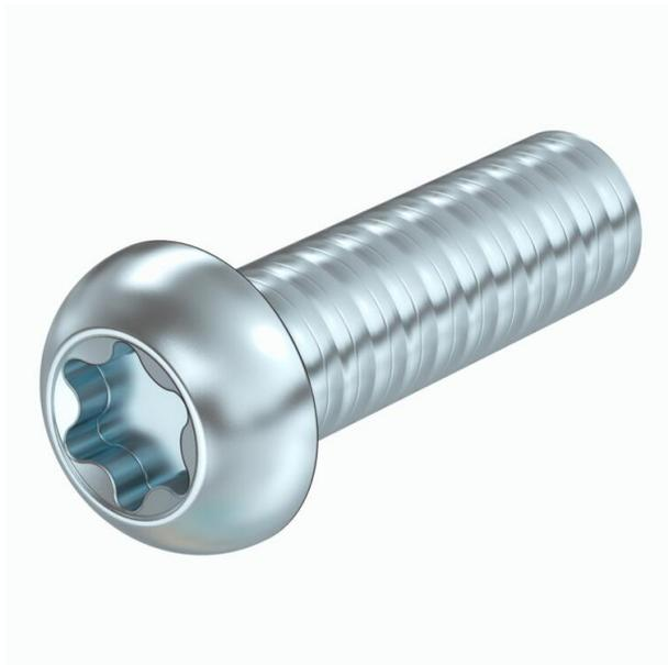
Vis à tête plate avec TX 30, selon ISO 7380-1, appropriée pour fixation de chemins de câbles sur consoles ainsi que pour le montage de séparateurs. La forme de tête arrondie permet d'assurer une protection optimale du câble. L'empreinte Torx permet une transmission de force optimale lors du mouvement de vissage.
