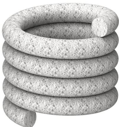
L'isolamento acustico serve a ridurre al minimo la trasmissione di rumore, ad es. durante il passaggio di un sistema di canali tra due uffici attraverso un'apertura praticata nella parete. L'isolamento acustico è composto da lana di vetro, che allo stato di fornitura ha un diametro di circa 30. Il materiale a metraggio è fornito in un cartone, la lunghezza del materiale è di 50 m. Durante il montaggio il materiale non deve essere compresso in modo eccessivo.
