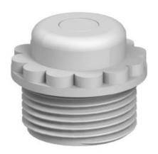
Con membrana perforabile, con foro D pretagliato, ma prima di tutto chiusa. Guarnizione a torsione per avvitamento in filettatura metrica secondo IEC 423. Con cono ad autotenuta sulla filettatura terminale, così da rendere superfluo l'impiego di una guarnizione interna per attacco filettato. Grado di protezione raggiungibile con montaggio accurato IP 54. Con membrana perforabile, con foro D pretagliato, ma prima di tutto chiusa.
