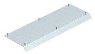
Coperchio cieco a pavimento per la copertura del canale di installazione sopra pavimento AIK, adatto alle parti inferiori del canale AIK/U. Il coperchio del canale è saldamente avvitato ai profili laterali in alluminio della parte inferiore del canale. L'inclinazione del coperchio supera la parte inferiore del condotto con un angolo di 45°.
