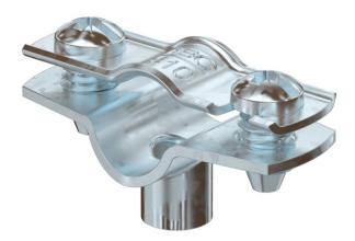
Collare di fissaggio per il montaggio di tubi e cavi a parete, soffitto e pavimento. Con elemento superiore autobloccante. Fissaggio sopra supporto con filettatura interna. Superfici G ed FT a partire dalla dimensione 20 dei collari adatte per montaggio con sparabulloni o sparachiodi.
