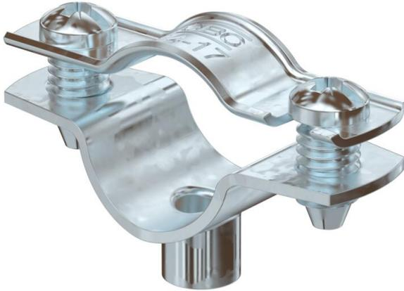
Collare di fissaggio per il montaggio di tubi e cavi a parete, soffitto e pavimento. Con elemento superiore autobloccante. Fissaggio sopra supporto con filettatura interna. Superfici G ed FT a partire dalla dimensione 20 dei collari adatte per montaggio con sparabulloni o sparachiodi.
