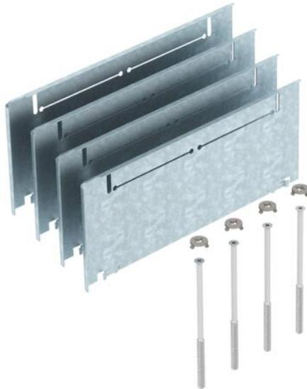
Höhenausgleich-Bausatz für Unterflurdosen UZD250-3 und UGD250-3 mit einer Bauhöhe von 70 bis 125 mm für die bauseitige Erhöhung der UZD/UGD auf eine Höhe von 115-170 mm, bestehend aus 4 Fallblechen, 4 Nivellierschrauben und 4 Drehverschlüssen.
