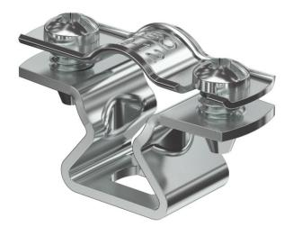
Collare di fissaggio per il montaggio di tubi e cavi a parete, soffitto e pavimento. Con elemento superiore autobloccante. Fissaggio tramite foro ovale. A partire dalla dimensione 20 dei collari idoneità per il montaggio con sparabulloni o sparachiodi.
