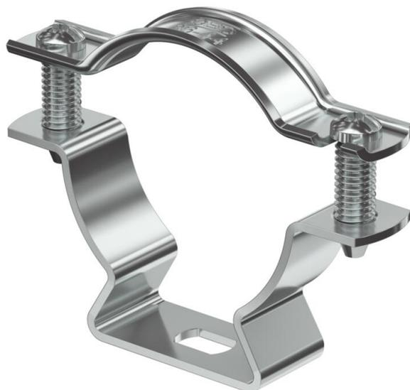
Collare di fissaggio per il montaggio di tubi e cavi a parete, soffitto e pavimento. Con elemento superiore autobloccante. Fissaggio tramite foro ovale. A partire dalla dimensione 20 dei collari idoneità per il montaggio con sparabulloni o sparachiodi.
