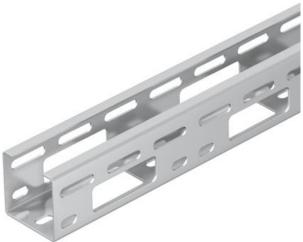
Petite goulotte AZ d'une hauteur d'aile de 50 mm. Atténuation magnétique du blindage sans couvercle 20 dB, avec couvercle 50 dB.
