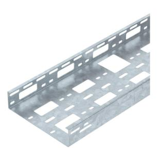
Petite goulotte AZ d'une hauteur d'aile de 50 mm. Atténuation magnétique du blindage sans couvercle 20 dB, avec couvercle 50 dB.
