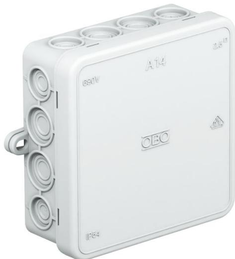
Tipo di protezione IP55, tensione nominale 690 V, sezione nominale 2,5 mm<sup>2</sup>, 8 fori entrata cavi per cavi di diametro di 5-14 mm
