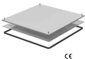
Bodenbelag-Einlegekassette für UZD350-3, zum Aufbau auf Unterflur-Zug- und - Abzweigdosen, zum Einsatz in trockenen Räumen mit trocken oder nass gepflegten Fußböden, für schnittfeste Bodenbeläge mit einer Stärke von 3 mm, bestehend aus: - Kassette mit innenliegendem Blinddeckel, - Ringdichtung zur Abdichtung und Trittschalldämmung und - V2A-Deckelbefestigungsschrauben.
