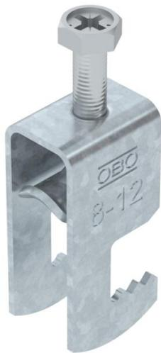
Bügelschelle mit F-Fuß, Metalldruckwanne mit gerundeten Kanten für Kabelschutz. Zur vertikalen und horizontalen Montage von 1 Einzelkabel an Flacheisen. Mit 1-gängiger Schraube an Druckwanne, universeller Sechskant-Schraubenkopf SW10, mit Schlitz und Kreuzschlitz. Geeignet für Montage im Innen- und Außenbereich. Der Einsatz einer Gegenwanne wird empfohlen.
