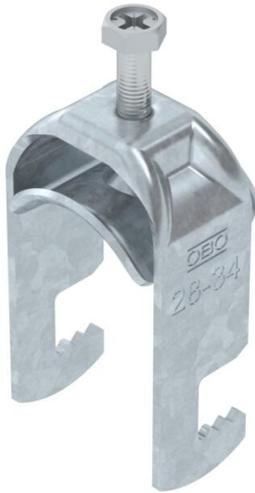
Bride de fixation avec pied F, plaque de pression en métal avec bords arrondis pour la protection des câbles. Pour montage vertical et horizontal d'1 câble individuel sur des fers plats. Avec vis à 1 filet sur plaque de pression, tête de vis hexagonale universelle SW10, avec fente et empreinte cruciforme. Convient au montage en intérieur et en extérieur. L'utilisation d'une contre-plaque est recommandée.
