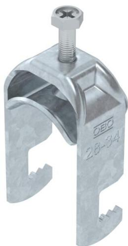
Staffa reggicavo con base a F, coppa in metallo con bordi arrotondati per proteggere il cavo. Per il montaggio verticale e orizzontale di 1 cavo singolo su profilato piatto. Con una vite sulla coppa premente, testa della vite esagonale universale da SW10, a taglio e a croce. Per il montaggio in ambienti interni ed esterni. Si consiglia di utilizzare una controcoppa.
