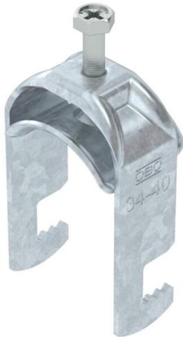
Bügelschelle mit F-Fuß, Metalldruckwanne mit gerundeten Kanten für Kabelschutz. Zur vertikalen und horizontalen Montage von 1 Einzelkabel an Flachseiten. Mit 1-gängiger Schraube an Druckwanne, universeller Sechskant-Schraubenkopf SW10, mit Schlitz und Kreuzschlitz. Geeignet für Montage im Innen- und Außenbereich. Der Einsatz einer Gegenwanne wird empfohlen.
