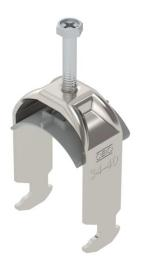
Bride de fixation avec pied tête de marteau, plaque de pression en matière plastique en polypropylène. Pour montage vertical et horizontal d'1 câble individuel sur des rails profilés en C. Pour une ouverture de 16 – 17 mm. Avec vis à 1 filet sur plaque de pression, tête de vis hexagonale universelle SW10, avec fente et empreinte cruciforme. Convient au montage en intérieur et en extérieur. L'utilisation d'une contre-plaque est recommandée.
