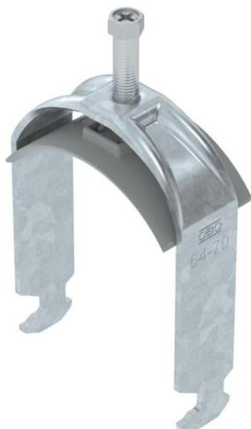
Bride de fixation avec pied tête de marteau, plaque de pression en matière plastique en polypropylène. Pour montage vertical et horizontal d'1 câble individuel sur des rails profilés en C. Pour une ouverture de 16 – 17 mm. Avec vis à 1 filet sur plaque de pression, tête de vis hexagonale universelle SW10, avec fente et empreinte cruciforme. Convient au montage en intérieur et en extérieur. L'utilisation d'une contre-plaque est recommandée.
