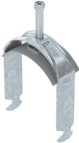
Bride de fixation avec pied tête de marteau, plaque de pression en matière plastique en polypropylène. Pour montage vertical et horizontal d'1 câble individuel sur des rails profilés en C. Pour une ouverture de 16 – 17 mm. Avec vis à 1 filet sur plaque de pression, tête de vis hexagonale universelle SW10, avec fente et empreinte cruciforme. Convient au montage en intérieur et en extérieur. L'utilisation d'une contre-plaque est recommandée.
