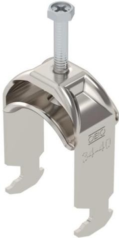
Bride de fixation avec embase à tête de marteau, plaque de pression en métal avec bords arrondis pour la protection des câbles. Pour montage vertical et horizontal d'1 câble individuel sur des rails profilés en C. Pour une ouverture de 16 – 17 mm. Avec vis à 1 filet sur plaque de pression, tête de vis hexagonale universelle SW10, avec fente et empreinte cruciforme. Convient au montage en intérieur et en extérieur. L'utilisation d'une contre-plaque est recommandée.
