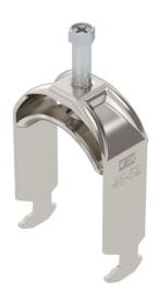
Staffa reggicavo con base a testa di martello, coppa in metallo con bordi arrotondati per la protezione del cavo. Per il montaggio verticale e orizzontale di 1 cavo singolo su profilato a C. Per dimensioni dell'asola di 16 - 17 mm. Con una vite sulla coppa premente, testa della vite esagonale universale da SW10, a taglio e a croce. Per il montaggio in ambienti interni ed esterni. Si consiglia di utilizzare una controcoppa.
