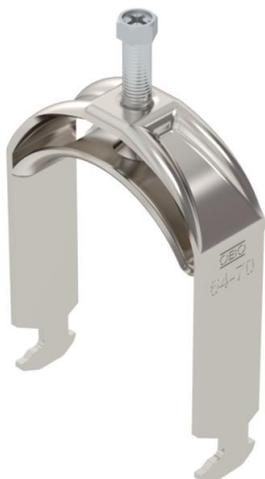
Bride de fixation avec embase à tête de marteau, plaque de pression en métal avec bords arrondis pour la protection des câbles. Pour montage vertical et horizontal d'1 câble individuel sur des rails profilés en C. Pour une ouverture de 16 – 17 mm. Avec vis à 1 filet sur plaque de pression, tête de vis hexagonale universelle SW10, avec fente et empreinte cruciforme. Convient au montage en intérieur et en extérieur. L'utilisation d'une contre-plaque est recommandée.
