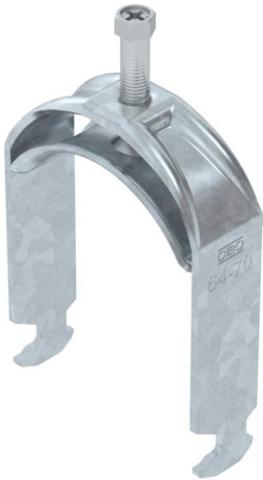
Bride de fixation avec embase à tête de marteau, plaque de pression en métal avec bords arrondis pour la protection des câbles. Pour montage vertical et horizontal d'1 câble individuel sur des rails profilés en C. Pour une ouverture de 16 – 17 mm. Avec vis à 1 filet sur plaque de pression, tête de vis hexagonale universelle SW10, avec fente et empreinte cruciforme. Convient au montage en intérieur et en extérieur. La contre-plaque doit être commandée séparément.
