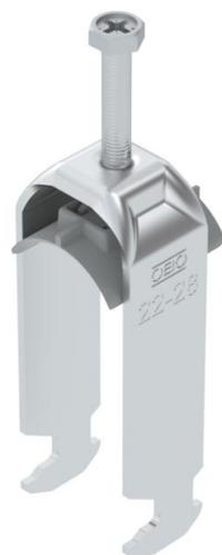
Staffa reggicavo con base a testa di martello, coppa in plastica di polipropilene. Per il montaggio verticale e orizzontale di 2 cavi singoli su profilato a C. Per dimensioni dell'asola di 16 - 17 mm. Con una vite sulla coppa premente, testa della vite esagonale universale da SW10, a taglio e a croce. Per il montaggio in ambienti interni ed esterni. Più cavi dovrebbero essere separati da coppe doppie. Si consiglia di utilizzare una controcoppa.
