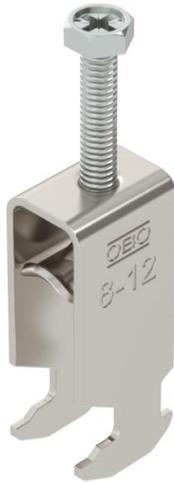
Bügel­schelle mit Hammerkopf-Fuß, Metall­druckwanne mit gerundeten Kanten für Kabelschutz. Zur vertikalen und horizontalen Montage von 2 Einzelkabeln an C-Profilschiene. Für Schlitzweite 16 - 17 mm. Mit 1-gängiger Schraube an Druckwanne, universeller Sechskant-Schraubenkopf SW10, mit Schlitz und Kreuzschlitz. Geeignet für Montage im Innen- und Außenbereich. Mehrere Kabel sollten durch Doppelwannen getrennt werden. Der Einsatz einer Gegenwanne wird empfohlen.
