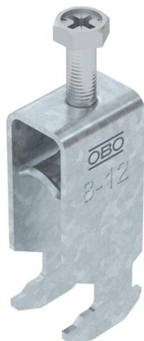
Staffa reggicavo con base a testa di martello, coppa in metallo con bordi arrotondati per la protezione del cavo. Per il montaggio verticale e orizzontale di 2 cavi singoli su profilato a C. Per dimensioni dell'asola di 16 - 17 mm. Con una vite sulla coppa premente, testa della vite esagonale universale da SW10, a taglio e a croce. Per il montaggio in ambienti interni ed esterni. Più cavi dovrebbero essere separati da coppe doppie. Si consiglia di utilizzare una controcoppa.
