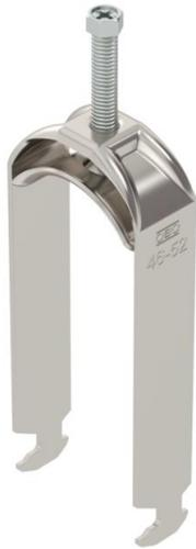
Bügelshelle mit Hammerkopf-Fuß, Metalldruckwanne mit gerundeten Kanten für Kabelschutz. Zur vertikalen und horizontalen Montage von 2 Einzelkabeln an C-Profilschiene. Für Schlitzweite 16 - 17 mm. Mit 1-gängiger Schraube an Druckwanne, universeller Sechskant-Schraubenkopf SW10, mit Schlitz und Kreuzschlitz. Geeignet für Montage im Innen- und Außenbereich. Mehrere Kabel sollten durch Doppelwannen getrennt werden. Der Einsatz einer Gegenwanne wird empfohlen.
