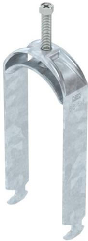
Bügelshelle mit Hammerkopf-Fuß, Metalldruckwanne mit gerundeten Kanten für Kabelschutz. Zur vertikalen und horizontalen Montage von 2 Einzelkabeln an C-Profilschiene. Für Schlitzweite 16 - 17 mm. Mit 1-gängiger Schraube an Druckwanne, universeller Sechskant-Schraubenkopf SW10, mit Schlitz und Kreuzschlitz. Geeignet für Montage im Innen- und Außenbereich. Mehrere Kabel sollten durch Doppelwannen getrennt werden. Der Einsatz einer Gegenwanne wird empfohlen.
